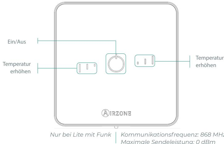
**Anmerkung:** Um den Lite-Einstellparameter aufzurufen, müssen Sie über die Zonenauswahl eines beliebigen Airzone Blueface zero-Thermostats auf die vom Lite-Thermostat geregelte Zone zugreifen. (Siehe Abschnitt Zonenkonfiguration).
