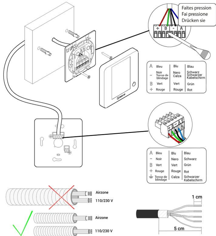
(FR) Ne pas connecter le pôle « - » sur le borne « + ». Cela pourrait endommager le dispositif.
