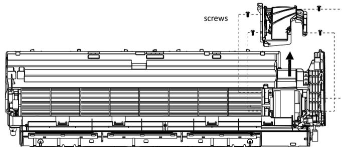
11. Disassembly fan motor and fan blade.
