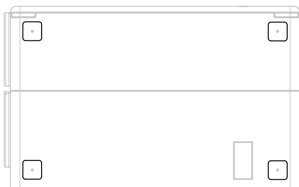
Miejsca klejenia stóp montażowych dla rekuperatora leżącego w pozycji standardowej.
